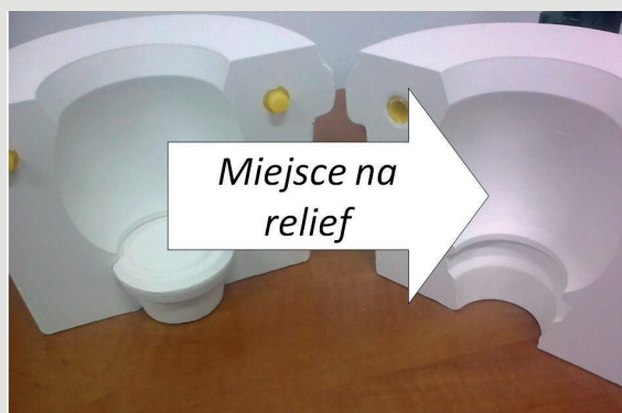
Rys. 1. Połowy formy gipsowej do odlewania ceramiki z zaznaczoną powierzchnią przeznaczoną do zdobienia za pomocą lasera (formy Ceramiki Artystycznej w Bolestawcu).
