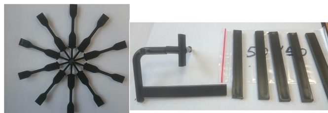
Rys. 5. Próbki do badań wytrzymałościowych.
