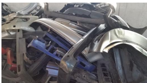
Rys. 2. Uszkodzone elementy samochodowe z tworzyw sztucznych (PP, PP/EPDM, PP/PE)
