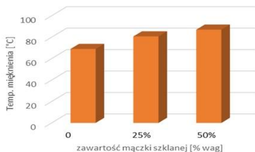
Rys. 7. Temperatura mięknięcia wg. Vicata kompozytów Prec/s modyfikowanych mączką szklaną
