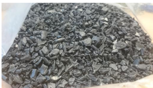
Rys. 3. Recyklat Prec/s z procesu rozdrabniania
