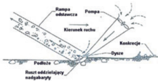
Rys. 15. Zasada działania pługa hydraulicznego [2] Fig. 15. Principle of hydraulic plow operation [2]
