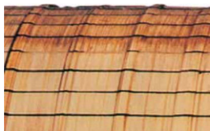
Rys. 11. Nierównomierne zużycie się powierzchni komutatora
