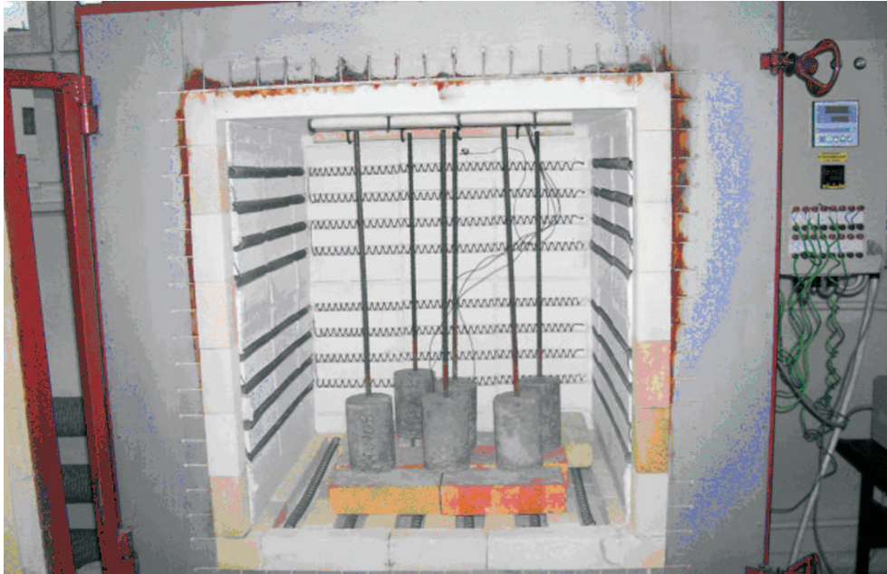
Rys. 6. Widok pieca PK 1100/5 wraz z umieszczonymi w środku próbkami do badań Źródło: opracowanie własne.
