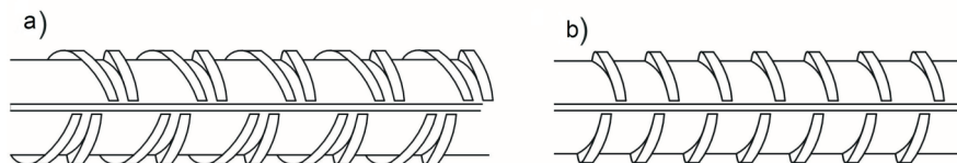
Rys. 2. Wzór użebrowania stali zbrojeniowej użytej do wykonania próbek a) Stal B500SP, b) Stal BSt500S
