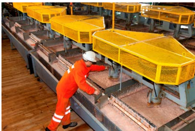
Ryc. 5. Sól potasowa w zakładzie przeróbczym w Suria poddawana jest procesowi flotacji (fot. Iberpotash S.A.)
