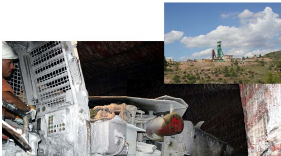
Ryc. 4. Kopalnia soli potasowych Villafruns w Sallent. Urabianie pokładu sylwinitu za pomocą kombajnu marki Alpina. Na zdjęciu górnym widoczny szyb zjazdowy i zabudowania kopalni.
