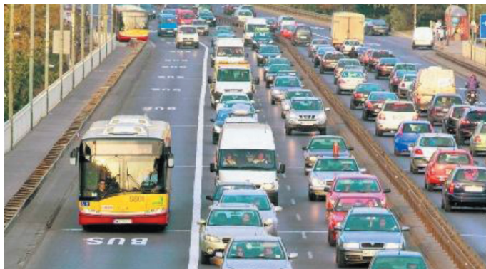
Fot. 1. Wydzielone pasy ruchu dla pojazdów transportu zbiorowego przejawem realizacji polityki zrównoważonego rozwoju
