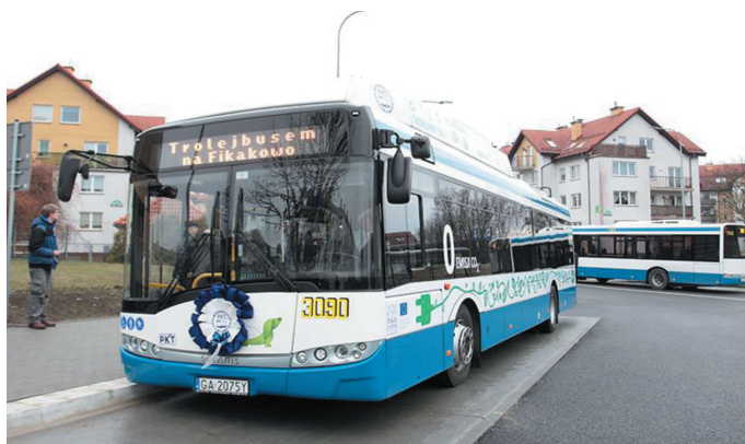
Fot. 3. Nowoczesny trolejbus wyposażony w baterie litowo-jonowe przejawem ewolucji trolejbusów w kierunku elektrobusem
