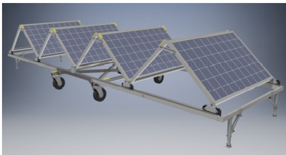
Rys. 4. Projekt mobilnego bloku fotowoltaicznego
