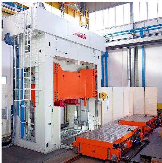
Rysunek 2.3 Prasa hydrauliczna o nacisku 1500 t [11]
