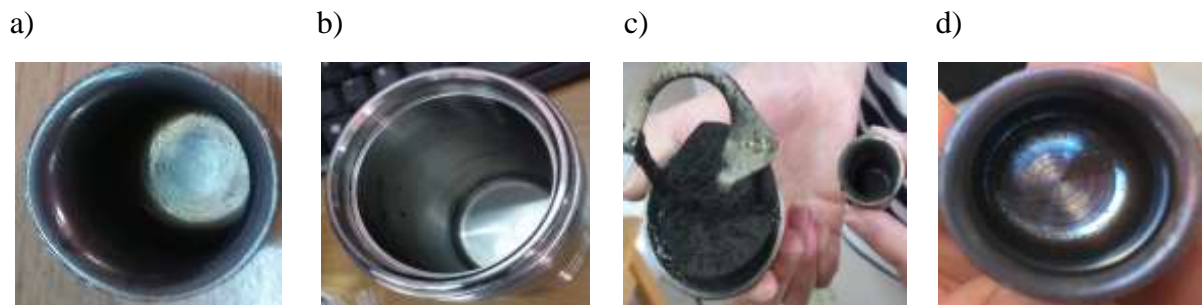
Rys. 3. Tygłe bomb kalorymetrycznych z pozostałościami produktów spalania: a) Ekodiesel ULTRA (laboratorium Politechniki Gdańskiej), b) „ECA Fuel” RMD 80 (laboratorium Politechniki Gdańskiej), c) RMG 380 (laboratorium Politechniki Gdańskiej), d) RMG 380 (laboratorium Lotosu)
