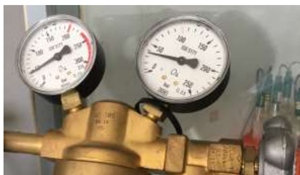
Rys. 4. Zawór redukcyjny zbiornika ciśnieniowego z tlenem zasilającym kalorymetr – wskazania ciśnienia tlenu na manometrach
