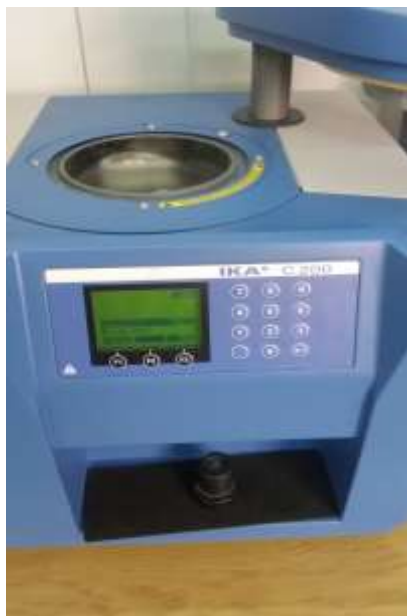
Rys. 1. Widok ogólny kalorymetru IKA C200 na stanowisku laboratoryjnym Katedry Aparatury i Maszynoznawstwa Chemicznego Wydziału Chemicznego Politechniki Gdańskiej (a), zbliżenie panelu sterowniczego (b)
