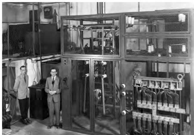
Rys. 4. Pierwsza jednofazowa zwarcioznia w rozbudowanym budynku katedry, na zdjęciu od lewej W. Winiarski i H. Dzierżek
