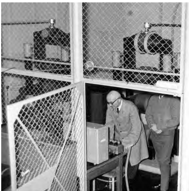
Rys. 5. Badania modelowe uziemień na stanowisku pomiarowym z wanną elektrolityczną, w środku późniejszy członek zespołu katedry Andrzej Wiśniewski
