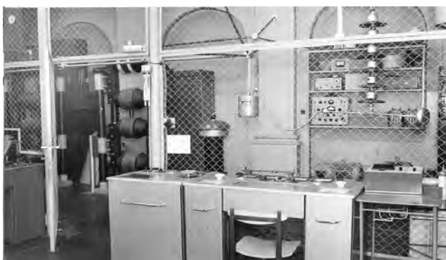
Rys. 6. Stanowiska do badania rozkładu napięcia na izolatorach liniowych przy napięciu 50 Hz metodą kompensacyjną
