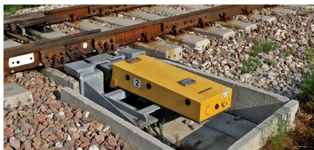
Rys. 2. Napęd zwrotnicowy typu EEA-5 umocowany do toru [6]
