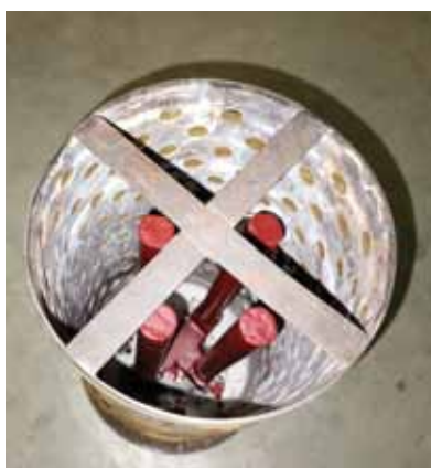
Rys. 12. Model woskowy oraz tuleja perforowana do wypełnienia gipsem Fig. 12. Wax model and perforated hollow to be filled with gypsum
