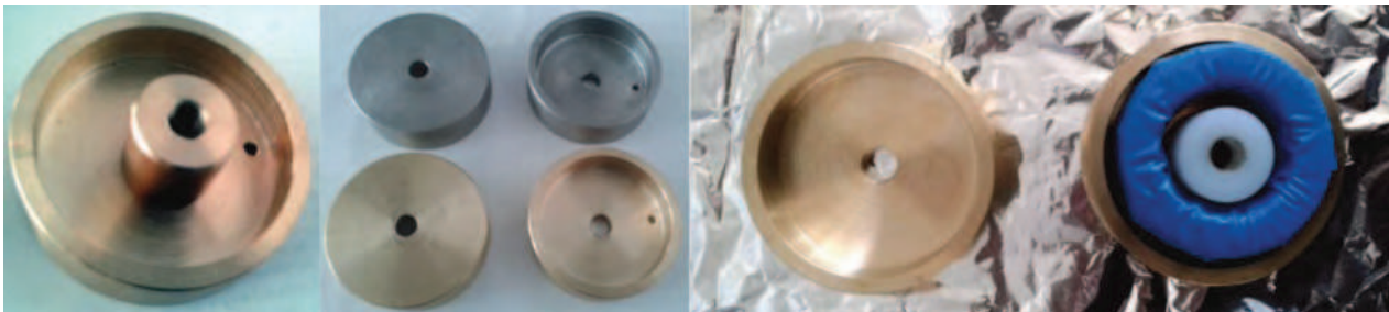
Rys. 4. Widok użytych ekranów cewki Rogowskiego (stalowy i miedziany) (opracowanie własne)
