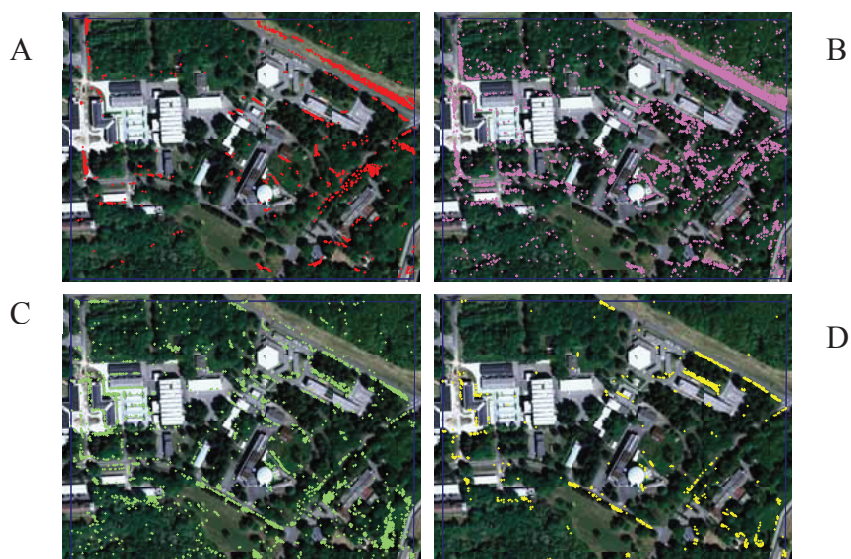
Rys. 7. Rozkład przestrzenny różnic pomiędzy NMT, a danymi źródłowymi wykorzystanymi do budowy NMT (wysokości pomierzone za pomocą skaningu laserowego), obszar testowy 1); A - \Delta H (-1.0; -0.2 m), B - \Delta H (-0.2; -0.1 m), C - \Delta H (0.1; 0.2 m), D - \Delta H (0.2; 1.4 m), na pozostałym obszarze \Delta H (-0.1; 0.1 m)
