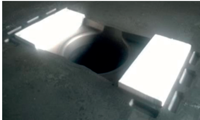
Rys. 17. Wnęka formy z preformami do nasączenia ciekłym metalem, służąca do wytwarzania płytek pancernych o osnowie metali lekkich Fig. 17. The mould cavity with preforms for soaking in molten metal for the production of light metal matrix armoured plates
