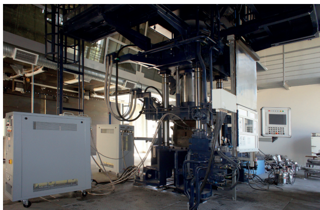
Rys. 13. Stanowisko do prasowania w stanie ciekłym i stało-ciekłym w oparciu o prasę hydrauliczną firmy UBE o sile zwierania 5000 kN
