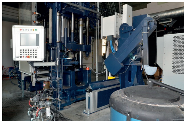
Rys. 13. Stanowisko do prasowania w stanie ciekłym i stało-ciekłym w oparciu o prasę hydrauliczną firmy UBE o sile zwierania 5000 kN
