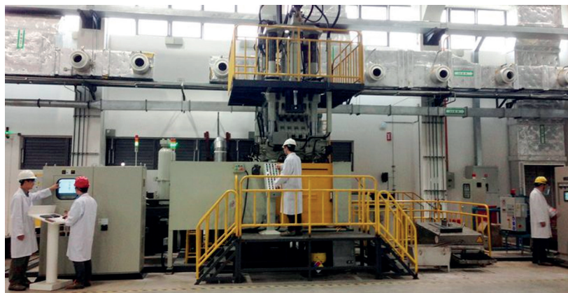
Rys. 9. Pionowa maszyna do prasowania metalu w stanie ciekłym dla stopów magnezu (VSC) [19] Fig. 9. A vertical squeeze casting machine for magnesium alloys (VSC) [19]
