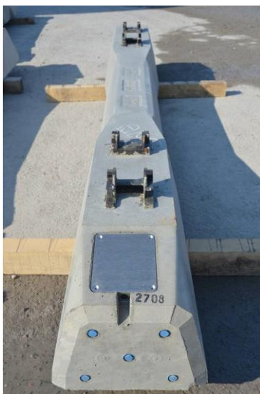
Rys. 4. Widok betonowego podkładu kolejowego wyposażonego w połączone światłowodami czujniki tzw. „siatki Bragga” (FBG) – fot. Cementys (zamieszczono za zgodą)
