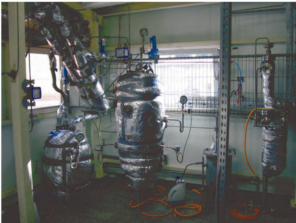
Rys. 2. Blok zasilania reaktora modułowego w media technologiczne Fig. 2. Technological media dosing block for modular reactor
