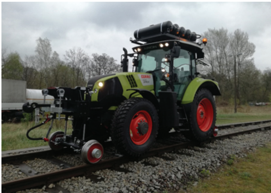
Rys. 6. Przykład pojazdu wyposażonego w zbiorniki służące do hamowania składem wagonów
