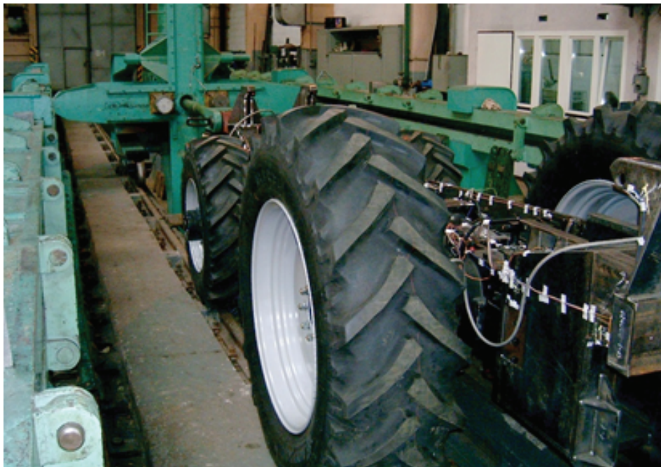
Rys. 4. Próba rozciągania pojazdu szynowo drogowego
