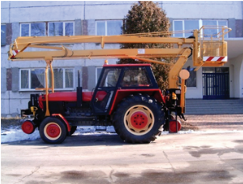
Rys. 1. Pojazd szynowo-drogowy z podnośnikiem koszowym
