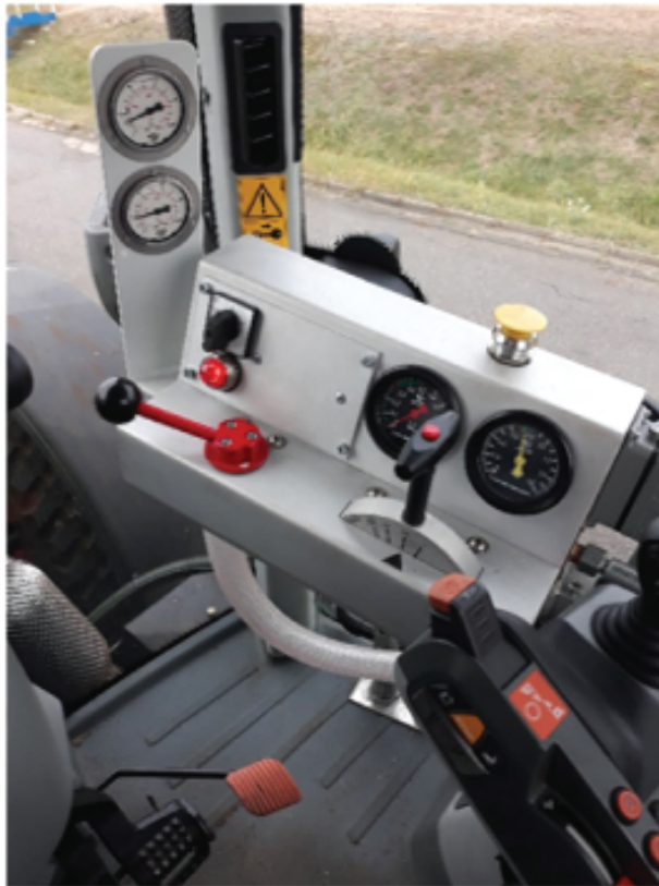
Rys. 7. Elementy układu hamulcowego zabudowanego w kabinie pojazdu szynowego Źródło: archiwum autora
