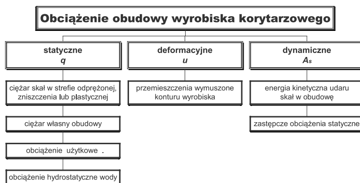
Rys. 1. Rodzaje obciążenia obudowy wyrobisk korytarzowych i komorowych [1,5,7]
