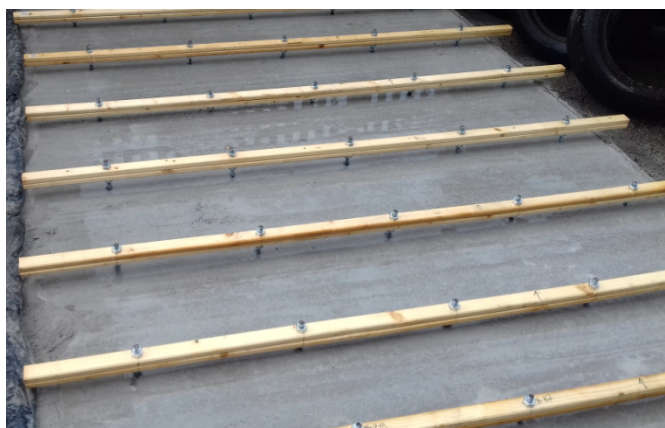
Rys. 8. Próbką do badań przyczepności zakotwione w płycie badawczej
