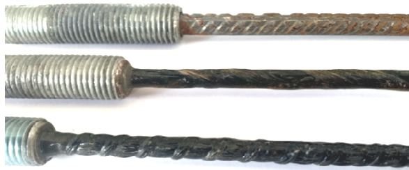
Rys. 4. Rodzaje prętów do badania przyczepności (od góry – pręt stalowy żebrowany, pręt bazaltowy bez żebrowania, pręt bazaltowy żebrowany)
