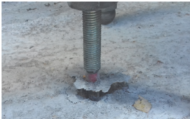
Rys. 9. Prawidłowy sposób zniszczenia próbki dla wklejonego pręta bazaltowego
