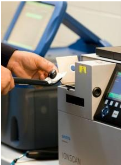
Foto. 4. Wykrywacz śladowych ilości materiałów wybuchowych (ETD)
