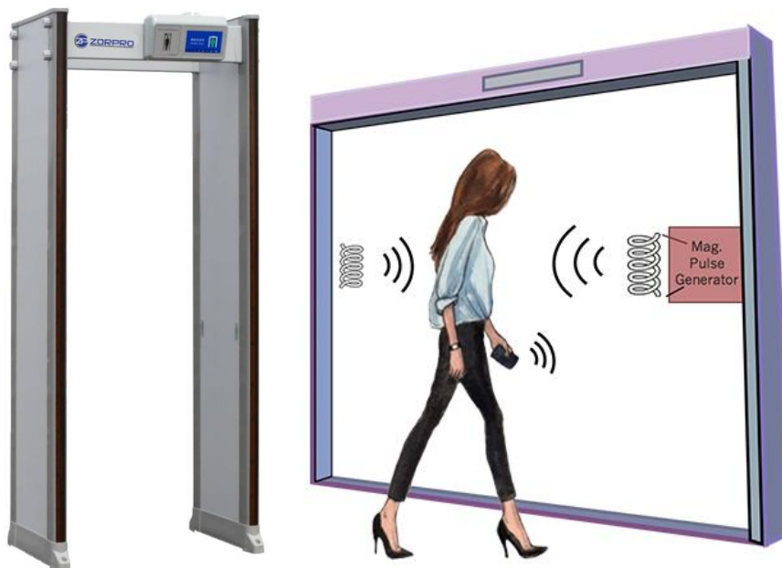
Rys. 3. Sposób działania wykrywacza metalu WTMD
