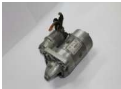
Rys. 1. Rozrusznik od fiata Punto
