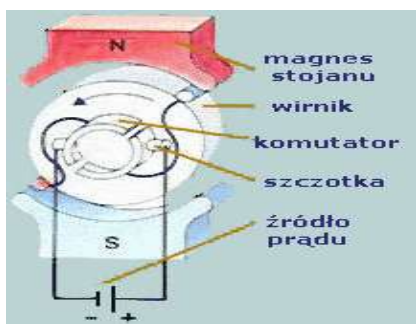
Rys. 2. Schemat zasilania elektrycznego w układzie rozrusznika pojazdu [12]
