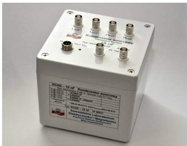
Rys. 1. Widok kondensatora wzorcowego 10 nF zbudowanego w GUM
