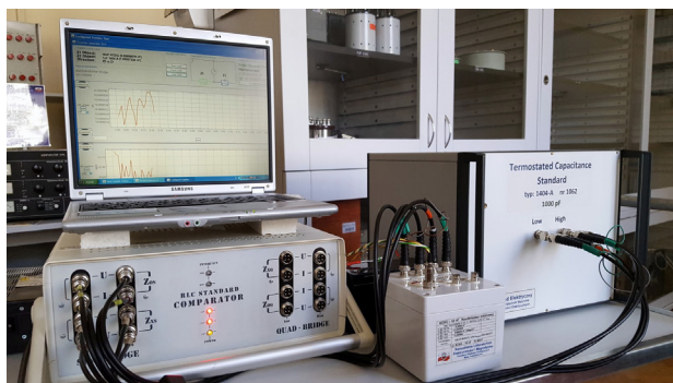
Rys. 4. Widok układu pomiarowego z komparatorem RLC 2100 i kondensatorami wzorcowymi
