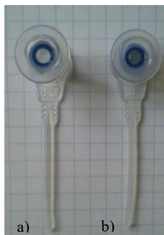
Rys. 5. Wygląd protez głosowych po przechowywaniu przez 122 dni: a) Provox2 12.5, b) Provox2 6.0
