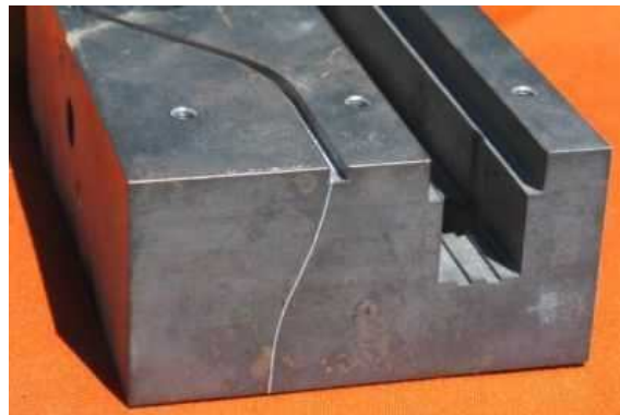
Rys. 13. Uszkodzenie narzędzia kuźniczego wskutek niewłaściwej konstrukcji Fig. 13. Forging tool damage caused by improper construction
