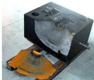
Rys. 11. Kruche pęknięcie matrycy wielowykrojowej – brak wstępnego podgrzania, koncentracja naprężeń
