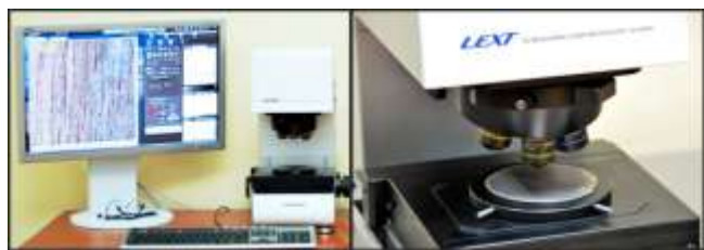
Rys. 1. Konfokalny laserowy mikroskop skaningowy LEXT OLS4000 firmy Olympus Fig. 1. Laser scanning confocal microscope LEXT OLS4000 produced by Olympus
