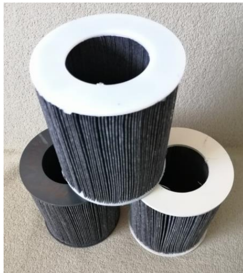
Rys. 3. Filtry wykonane przy zastosowaniu Promiennika podczerwieni A (krótkofalowego) [13].
