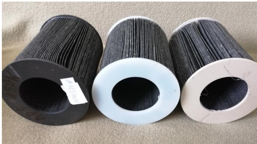
Rys. 4. Filtry wykonane przy zastosowaniu kleju termoplastycznego Pattex Hot Sticks [13].
