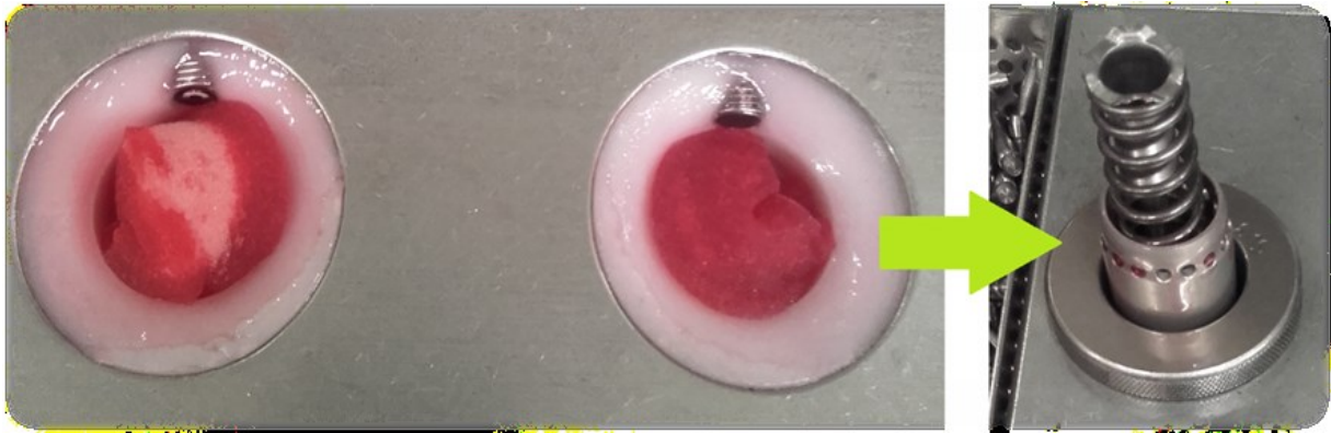
Figure 6. Sponges properly soaked with oil and a properly greased piston. Source: Posmyk, 2018: Analiza i ograniczenia powstawania wad w procesie produkcyjnym pomp hamulcowych , Zabrze.
