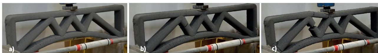
Rys. 7. Widok zniszczenia kratownicy: a) kratownica podczas badania; b) zniszczenia krzyżulca; c) zniszczenia pasa górnego
