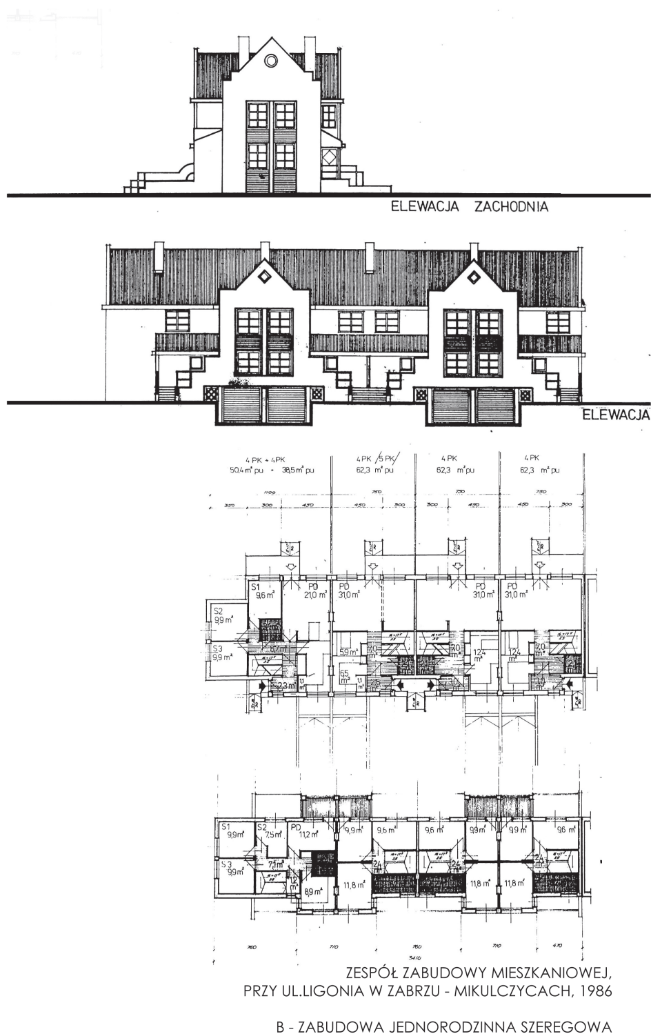
Rys. 7. Projekt zabudowy szeregowej w zespole mieszkaniowym przy ul. Ligonia w Zabrze. Widoki elewacji i rzuty kondygnacji mieszkalnych. Fig. 7. Project of the terrace building development in the housing team by the Ligonia st. in Zabrze. Views of the elevations and throws of residential storeys.
