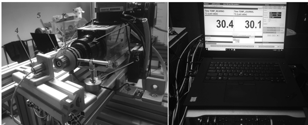
Fig. 2. Test rig and measurement system: 1 – bearing manufactured using the MJP technology, 2 – drive, 3 – force sensor, 4 – sensor used to measure the temperature of the shaft, 5 – sensor used to measure the temperature of the sleeve Rys. 2. Stanowisko badawcze wraz z układem pomiarowym: 1 – łożysko wykonane technologią MJP, 2 – napęd, 3 – czujnik siły, 4 – czujnik temperatury wału, 5 – czujnik temperatury panwi łożyska
