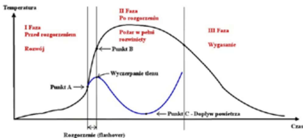
Rys. 2. Fazy rozwoju pożaru wraz z zaznaczeniem momentu wystąpienia zjawiska rozgorzenia oraz backdraft (wykres za punktem C).
