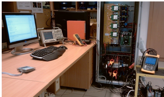
Rys. 9. Stanowisko badawcze z przekształtnikowym kompensatorem mocy biernej przygotowane do badań
