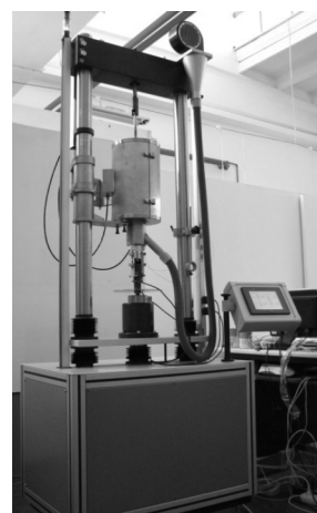
Rys. 1. Widok wielofunkcyjnego urządzenia do testów pełzania Fig. 1. View of the multifunctional creep tester
