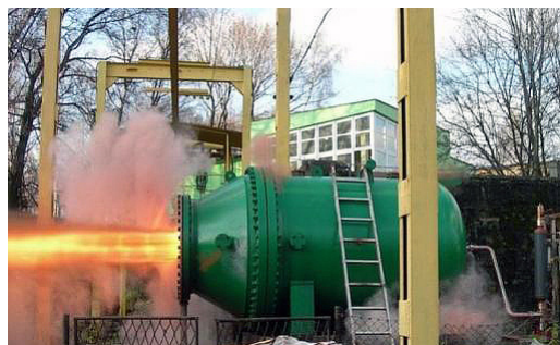
Rys. 6. Komora doświadczalna o objętości 5 m 3
