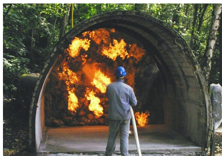
Rys. 7. Stanowisko do gaszenia metanu
