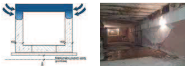
Rys. 7. Schemat (rozkład) ruchu wody w przekroju podziemnego przejścia
