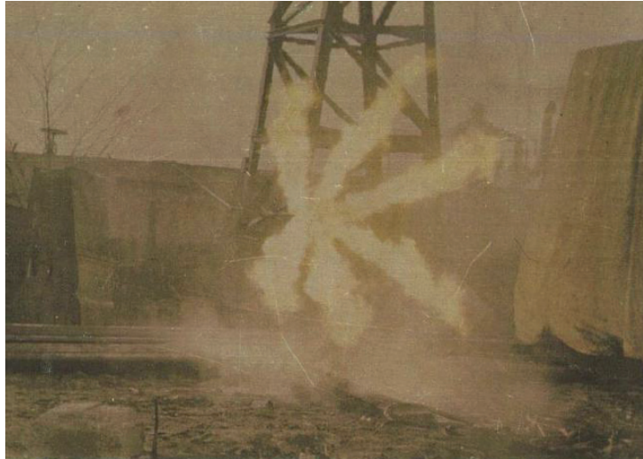
Rys.6. Struktura żagwi płomienia gliceryny technicznej o wydajności 1000 kg/h.
