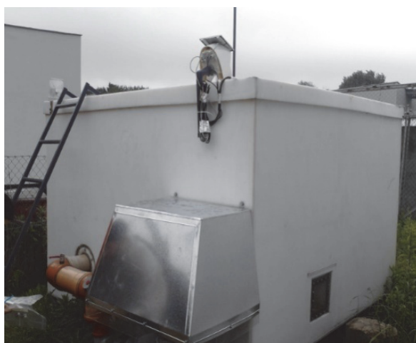
Fot. 1. Stanowisko badań biofiltracji gazu składowiskowego w skali polowej (fot. M. Zdeb)
