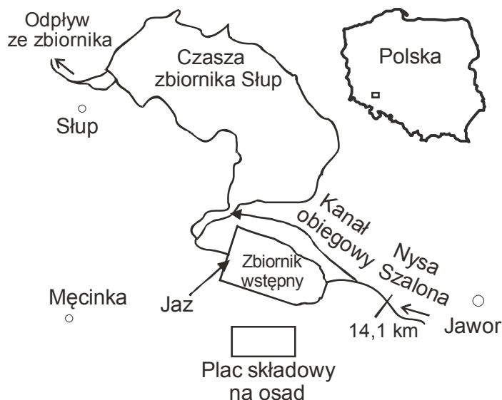
Rys. 1. Lokalizacja zbiornika wstępnego w cofce zbiornika Słup na rzece Nysa Szalona wraz z jazem, punktem poboru próbek wody do badań fizykochemicznych, placem do składowania osadów dennych i kanałem obiegowym Fig. 1. Locations of: the pre-dam reservoir in the Słup reservoir backwater on the Nysa Szalona River, the weir, water sampling point for chemical and physical analyses, bottom sediments storage site and the bypass channel
