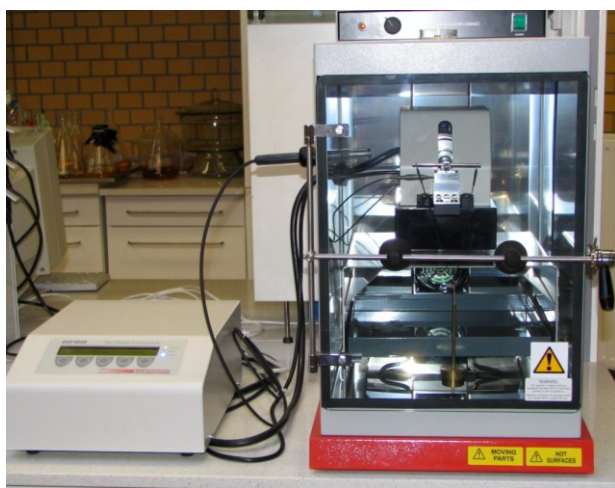
Рис. 3. Аппарат по определению смазывающей способности топлив и масел типа HFRR фирмы PCS Instruments
