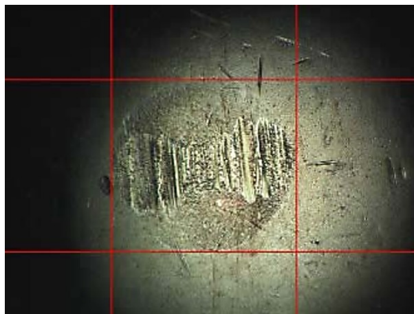
Рис. 4. Микроскоп HFR2 фирмы PCS Instruments и измеряемый след износа
