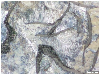
Fig. 8c: GJL 300 Sn-as cast
