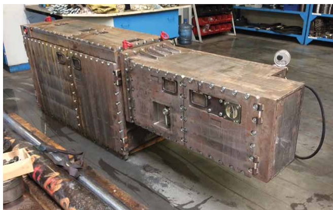
Rys. 3. Osłona przeciwwybuchowa układu zasilająco-sterującego [7]
