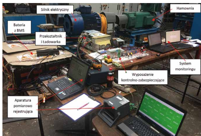
Rys. 2. Wyposażenie elektryczne układu zasilająco-sterującego na stanowisku badawczym [7]
