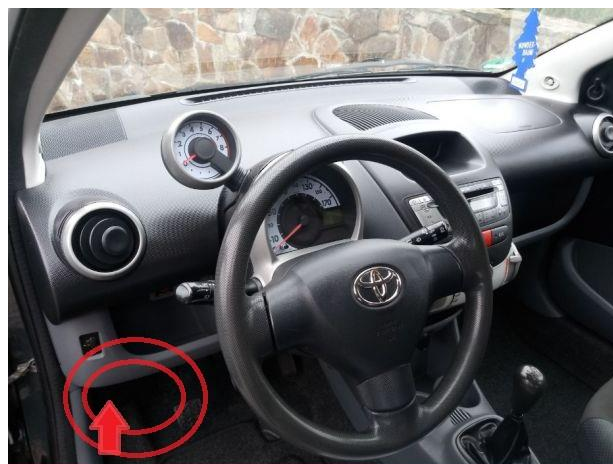
Rys. 4. Umieszczenie lokalizacji złącza OBD na przykładzie samochodu osobowego Toyota Aygo [opracowanie własne].
