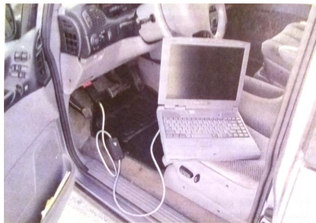
Rys. 7. Podłączenie komputera PC do złącza DLC [3].
