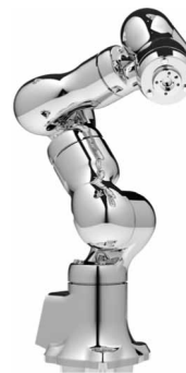
Rys. 6. Siedmioosiowy manipulator MS005N wykonany ze stali nierdzewnej firmy Kawasaki
