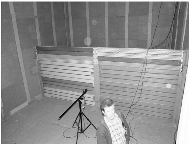
Rys.5. Komora pogłosowa wraz z zabudowanym ekranem i nakładką redukującą. Fig.5. Reverberation chamber with sound barrier and edge cover.
