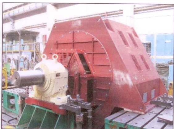
Rys. 1. Widok silnika asynchronicznego synchronizowanego nad silnikiem synchronicznym, typ: SASf-1612LX.
