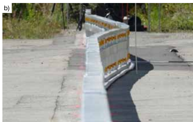
Rys. 7. Testy zderzeniowe: a) bariera przygotowana do testów, b) bariera po teście zderzeniowym
