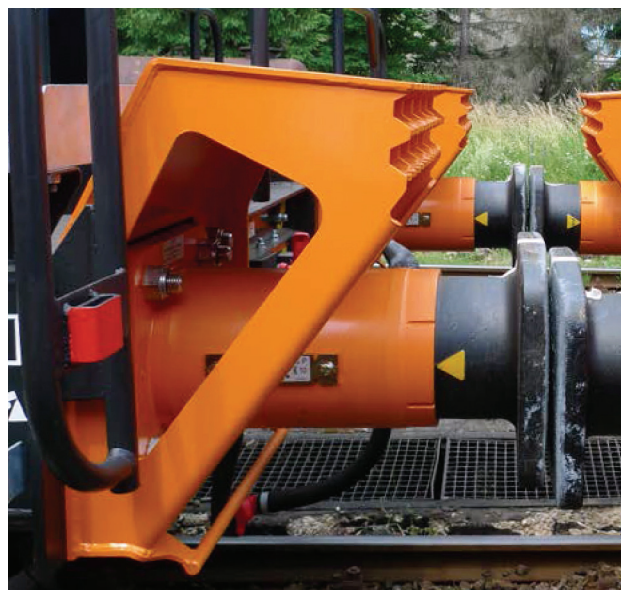
Rys. 4. Moduł antywspiniowy EST AC04 oraz odkształcalny zderzak pochłaniający energię zderzenia EST G2 [6]
