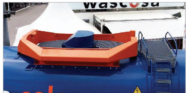
Rys. 7. Moduł o oznaczeniu UE01 zabezpieczający zawory zbiornika przy przewróceniu [1]
