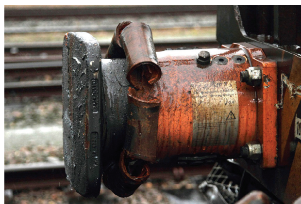
Rys. 2. Zderzak pochłaniający energię zderzenia po odkształceniu plastycznym pochwy [7]
