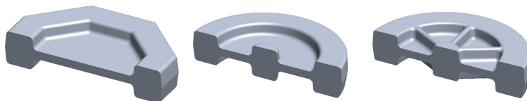
Rys. 7 Typowe odkuwki o zarysie zbliżonym do kołowego
